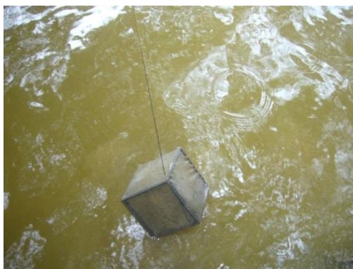
Figura 4. 9- Introdução da caixa de recolha de macroinvertebrados, no ponto de recolha com condições lânticas
